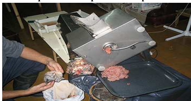
FOTO N° 9 Máquina utilizada para cortar el pescado.
