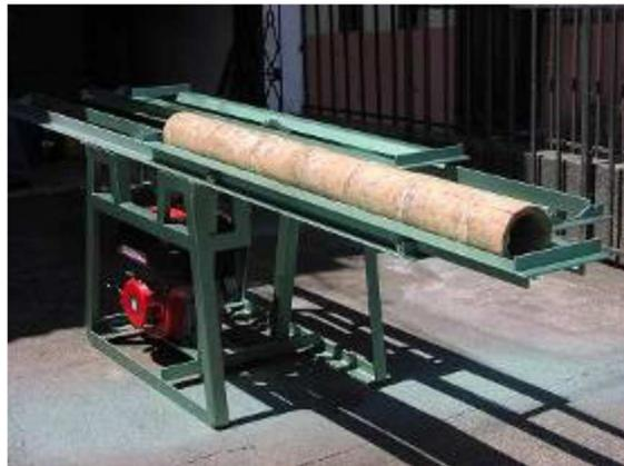
Fig. 2) Sierra paralela para latillar
