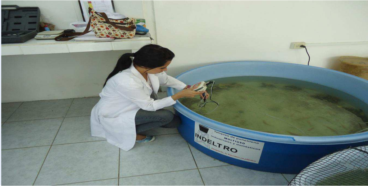
Foto 9: Tomando datos de temperatura, OD, pH con el medidor multi-parametros
