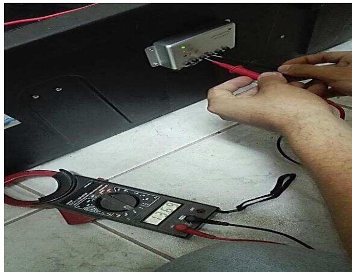
*Ilustración 49: Medición voltaje batería el día 29/01/2018
