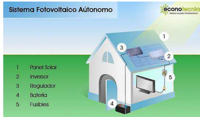
Ilustración 11: Sistema Solar Fotovoltaico Autónomo
