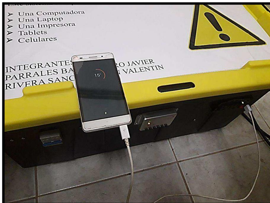
**Anexo 24: Colocación de extensión para conectar PC de escritorio al Sistema Solar Fotovoltaico.**
