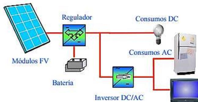
Ilustración 13: Generadores Fotovoltaicos – Estructura básica
