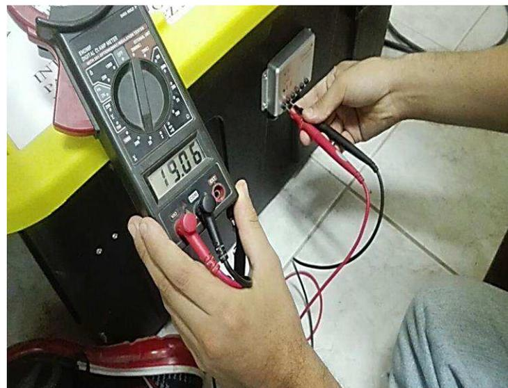
*Ilustración 55: Medición voltaje panel solar el día 05/02/2018
