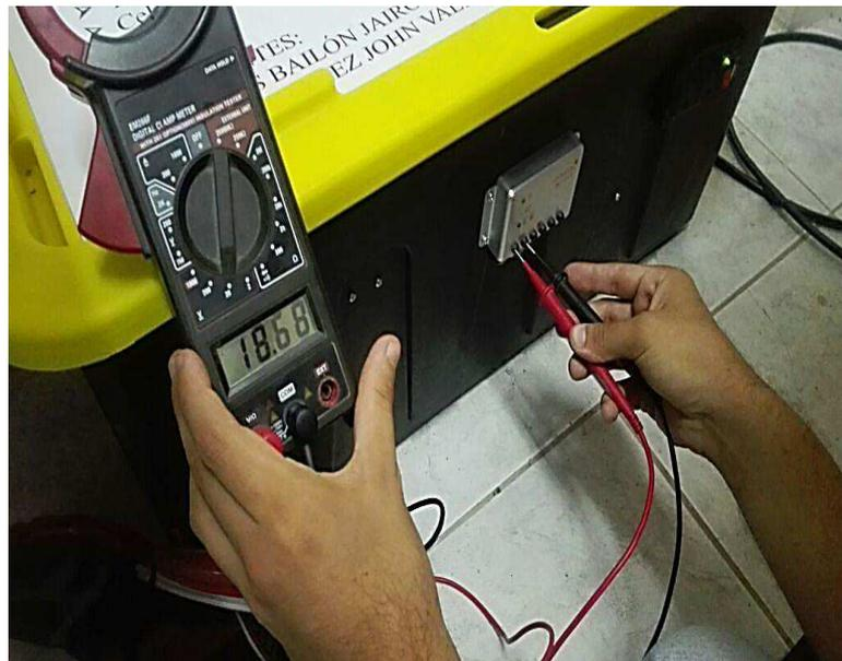
*Ilustración 57: Medición voltaje panel solar el día 07/02/2018
