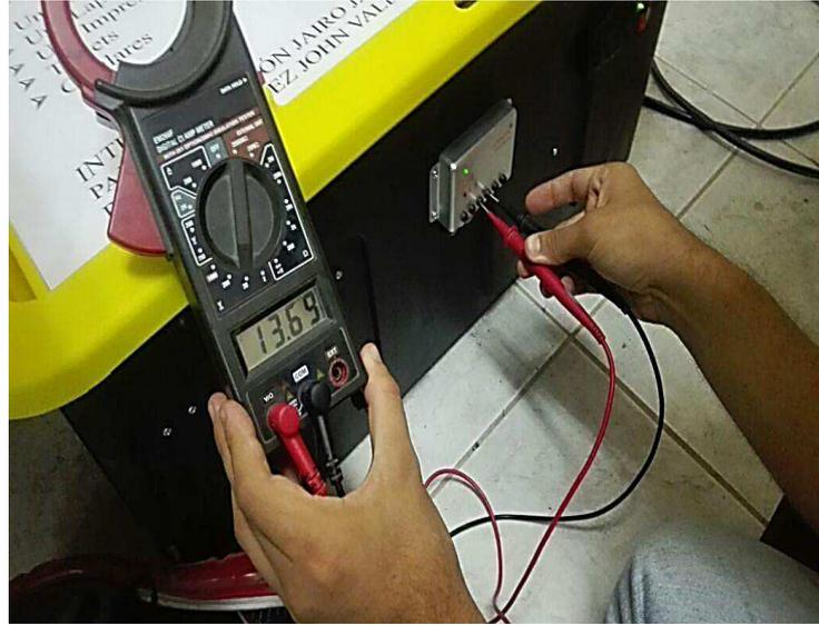
*Ilustración 56: Medición voltaje batería el día 07/02/2018
