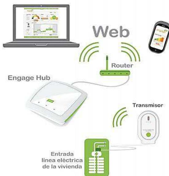
Ilustración 59: Croquis del funcionamiento de ENgage HUB
