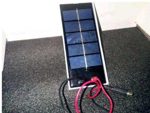
Cuando se realiza la electrolización con el panel solar este proceso dura al menos 10 minutos para obtener la producción completa de hidrógeno y oxígeno, si se realiza con baterías este proceso toma solo un par de minutos.
