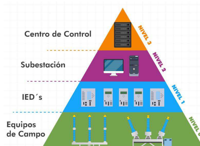
Figura 30. Niveles de control en subestaciones eléctricas
