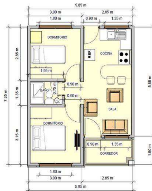
Imagen N° 4 – Proyecto de vivienda de interés social “Mucho Lote” – Planta arquitectónica
