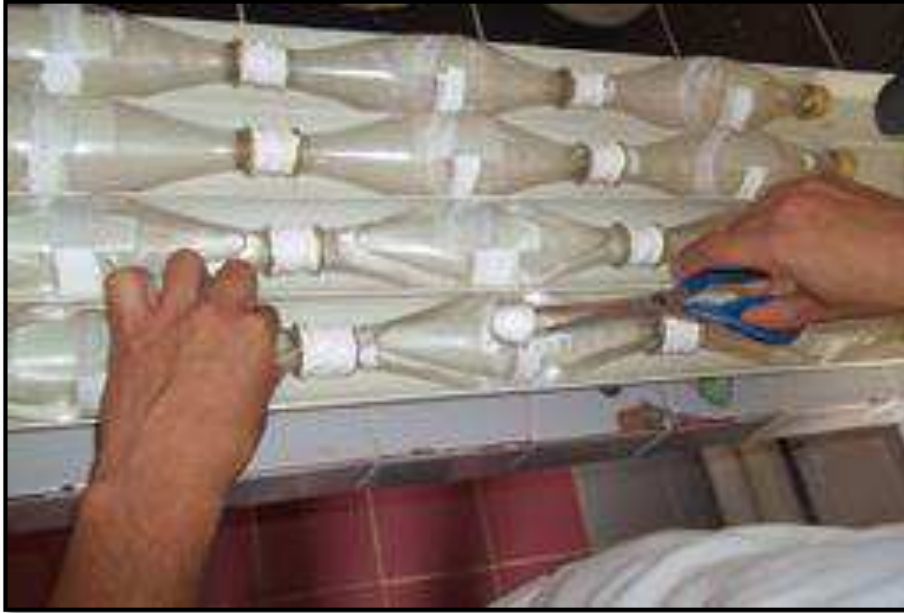
Foto 5. Colocación de los tapones y formación del gradiente de contaminación
