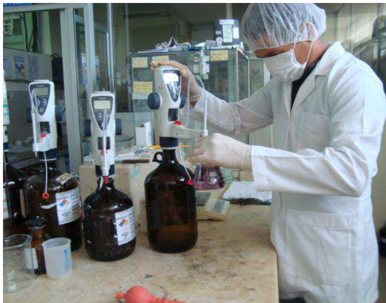
Fig. 22 Titulación al destilado de ácido bórico con ácido clorhídrico hasta obtener un color lila rosáceo.
