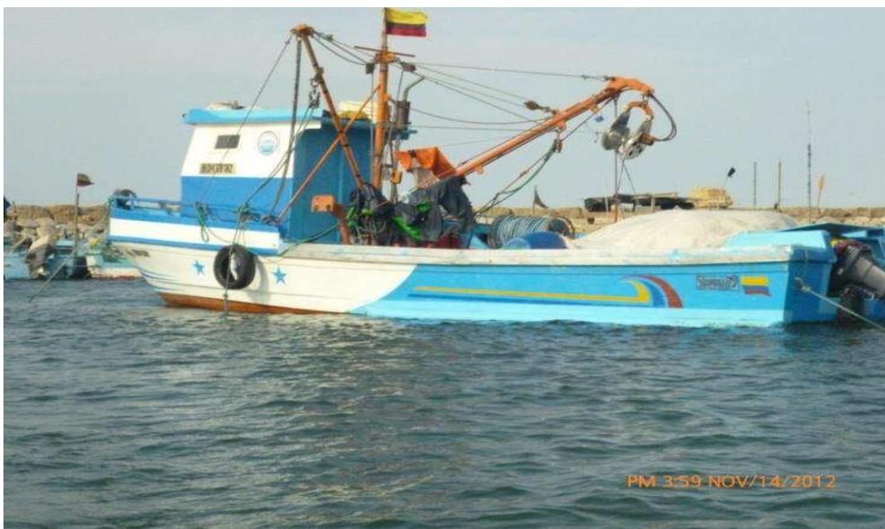
**Figura 3.** Ejemplar de embarcación construida de material de fibra de vidrio y con medios de propulsión fuera de borda.
