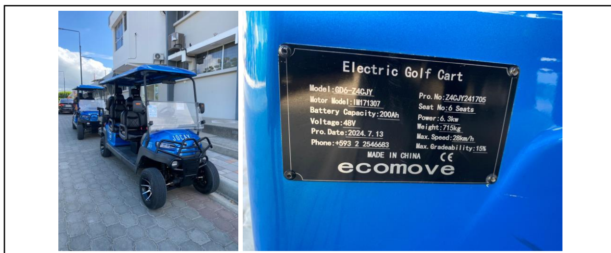
Gráfico 7. Muestra el carro eléctrico de golf junto con su placa característica. Fuente: Elaboración propia
