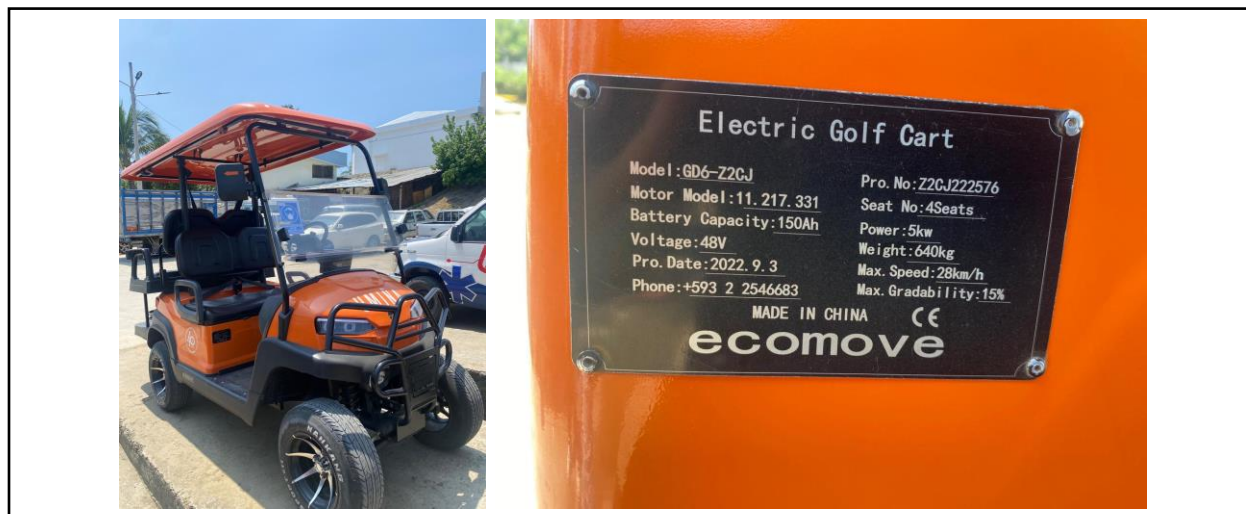
Gráfico 6. Muestra el carro eléctrico de golf junto con su placa característica. Fuente: Elaboración propia
