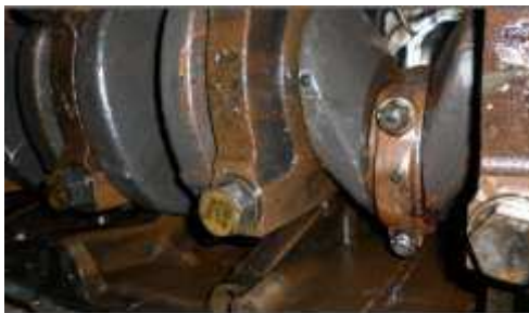
Estado de Cigüeñal (Óxido)
