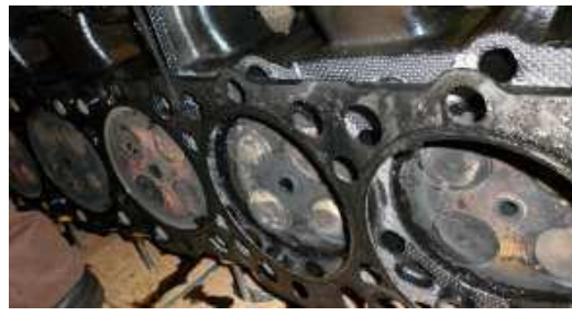
Estado de culata (óxido)
