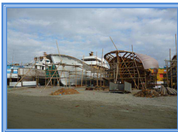
Foto 6: Reconstrucción de Embarcaciones Pesqueras Tipo de madera recubierta con fibra de vidrio. Fuente: Captada por Adrián Zambrano en Astillero de Manta
