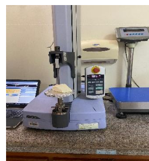
Imagen 14. Análisis de firmeza con el texturométero.
