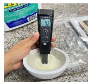
Imagen 15. Medición de pH en las muestras.
