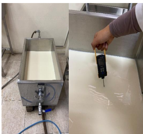
Imagen 5. Calentamiento de la leche y control de su temperatura.
