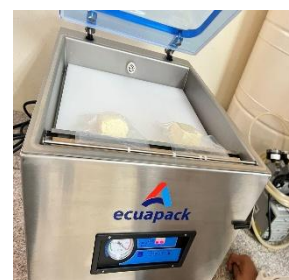
Imagen 10. Sellado al vacío de las muestras.
