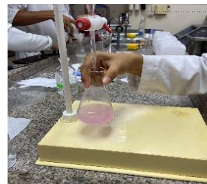
Imagen 11. Análisis de acidez por medio de titulación.
