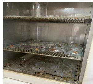
Imagen 12. Muestras disecadas en la estufa.
