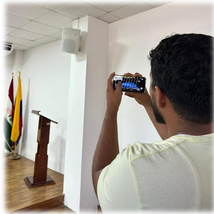
Ilustración 51. Proceso de medición de respuesta en frecuencia en sitio
