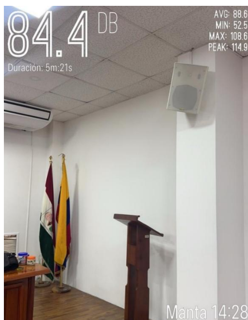
Ilustración 53. Medición de SPL en la zona A del auditorio.
