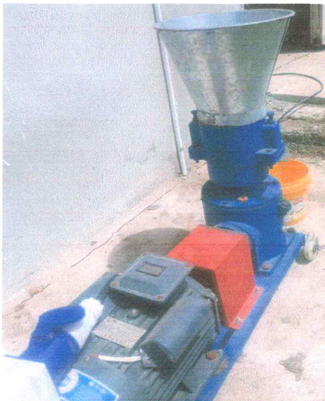
Anexo 1.- Máquina pelletizadora utilizada en el proceso experimental de pelletizado en la Finca Tigrillo.
