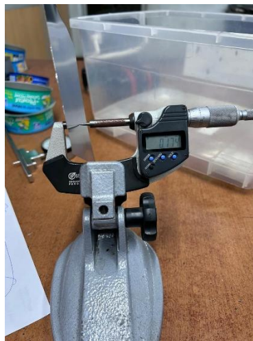
Figura C 2 Medición de espesor de la hojalata mediante micrómetro digital.
