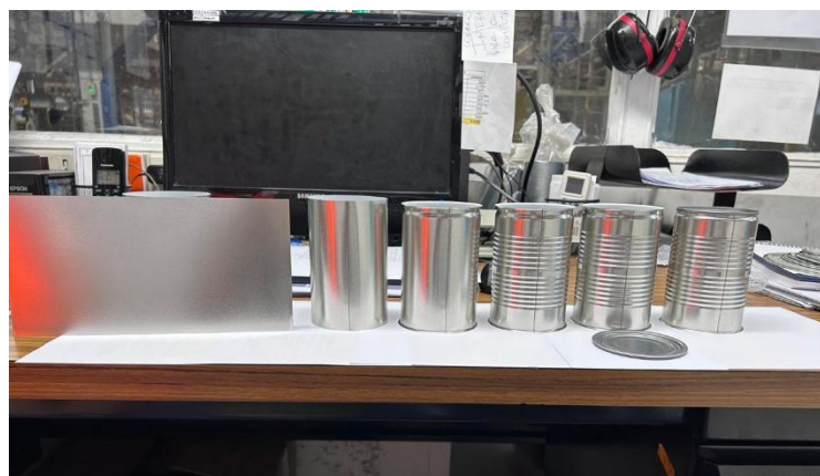
Figura C 5 Secuencia de cuerpos de envases formados durante la evaluación del proceso
