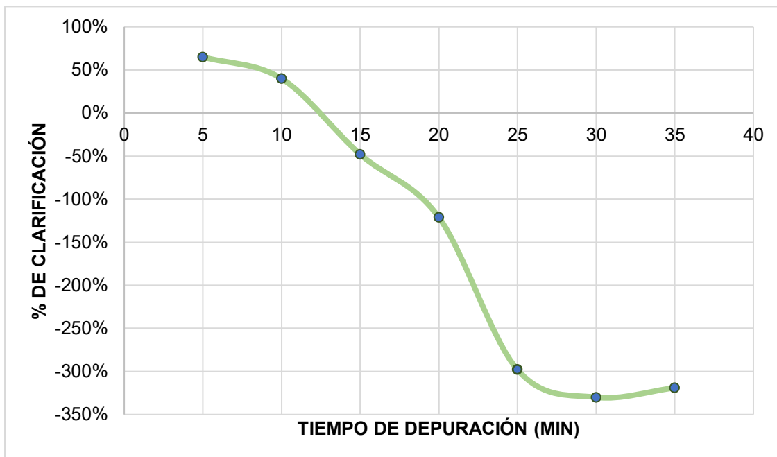
Figura 11. Variación del porcentaje de clarificación de la dilución de Power rojo con agua potable en función del tiempo de depuración
