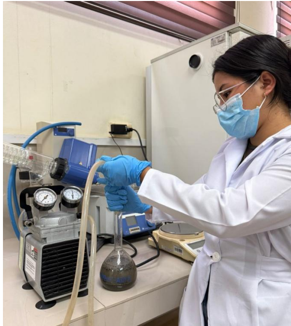
FIGURA 14. Proceso para determinación de peso específico
