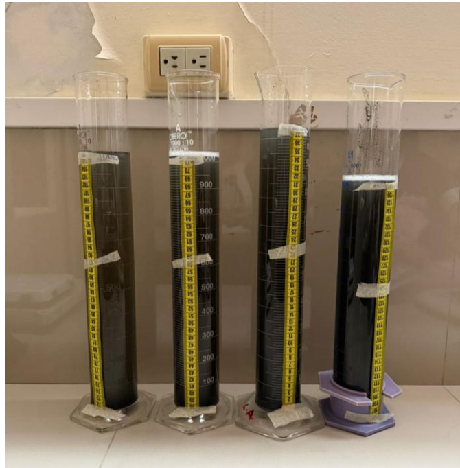
FIGURA 12. Ensayo de columnas de sedimentación con diferentes concentraciones
