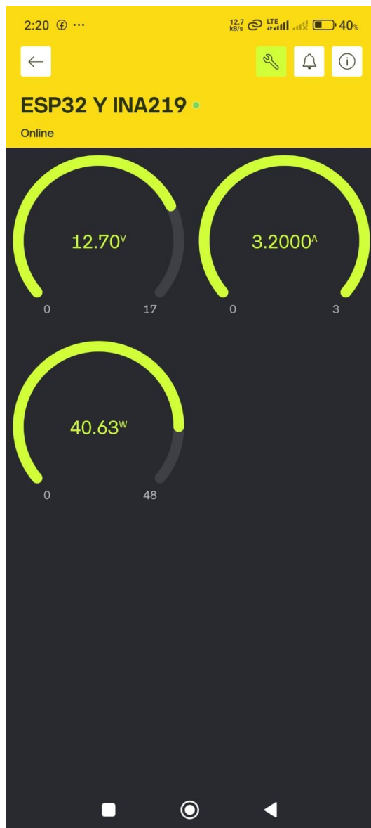
Ilustración 5. Monitoreo a través del celular con Blynk IoT
