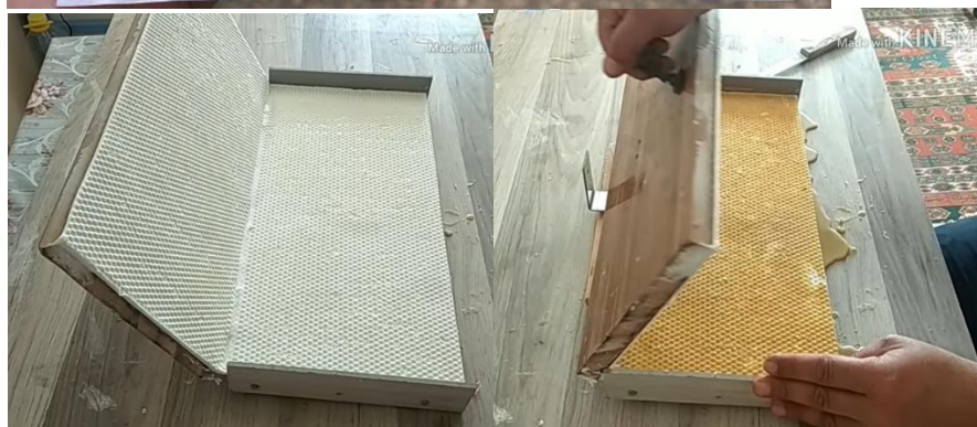
Proceso de laminación de cera de abeja mediante laminadora artesanal, utilizada para el análisis de las variables flexibilidad, espesor, y pH, en el cantón El Carmen, provincia de Manabí
