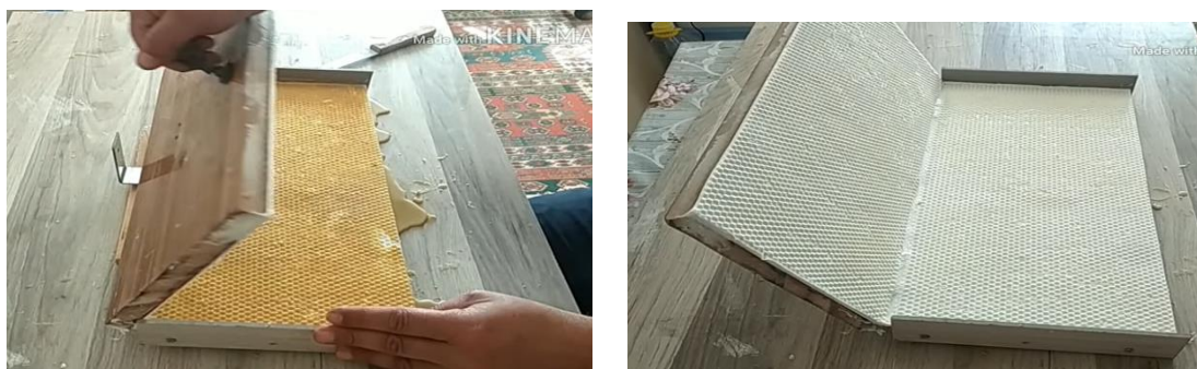
Laminadora con base y tapa de madera incorporada la silicona con filos de acero para sostener y evitar riegue
