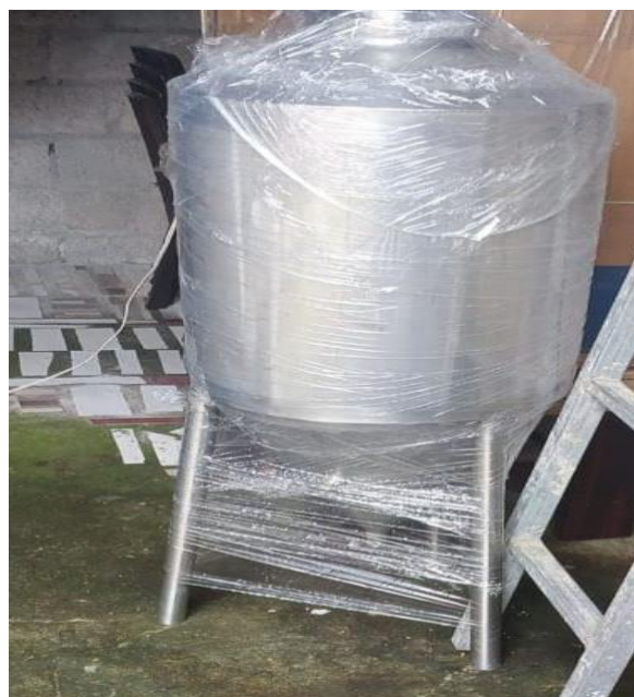
Figura 3. Fermentador batch de acero inoxidable de 100 L con tapa hermética y válvulas de entrada y salida
