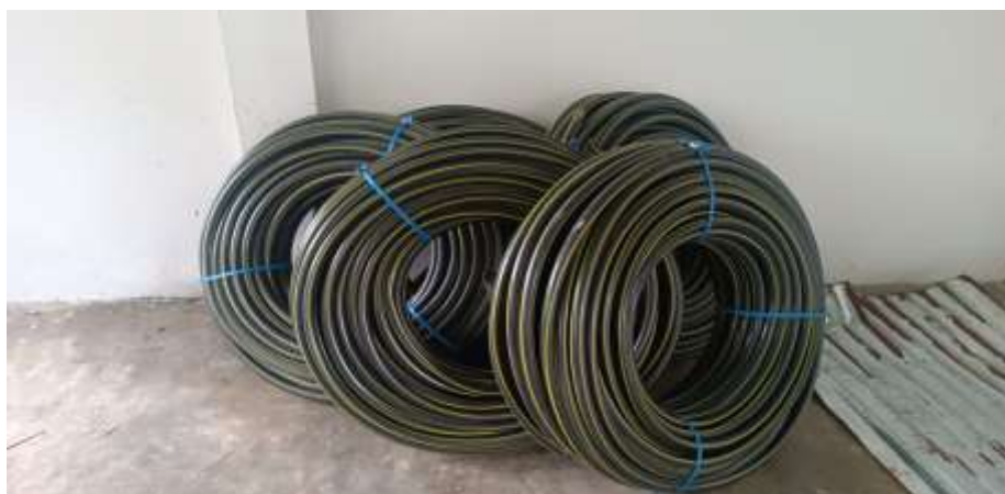
Figura 6. Rollos de manguera de polietileno de alta densidad (PEAD) utilizados en la red principal y secundaria del sistema de riego.
