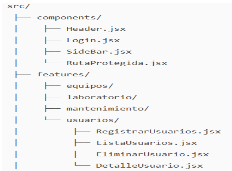
Figura 11 Estructura del módulo de usuarios
