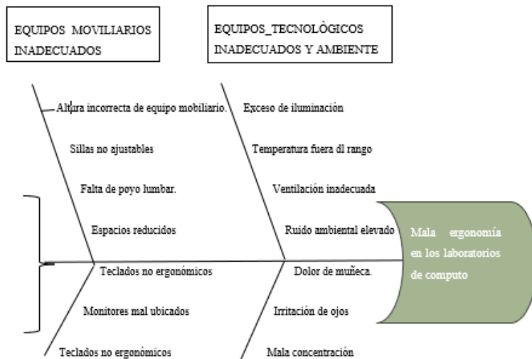
Ilustración 4 Diagrama Causa-Efecto del proyecto.
