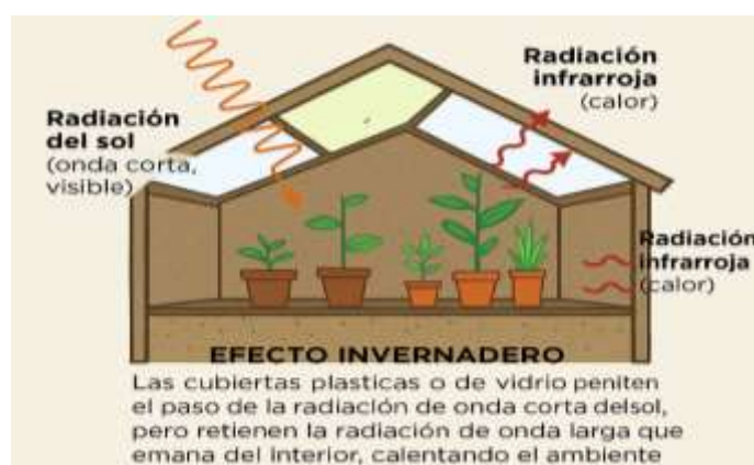
Figura 3. Presentación del efecto invernadero en estructuras protegidas
