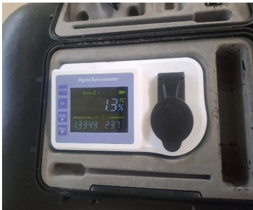
Medición de grados Brix etapa alcohólica
