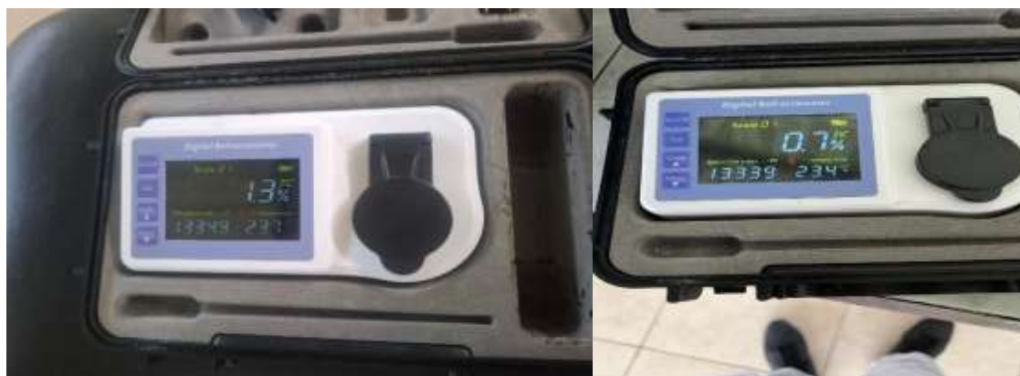
Figura 6. Refractómetro digital empleado para la determinación de sólidos solubles (°Brix) en los sustratos fermentados de mucílago de cacao durante el proceso de fermentación acética
