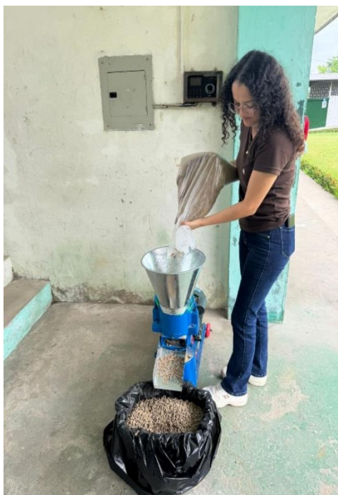
Anexo 4. Proceso de realizacion del pellet con harina (premezcla)
