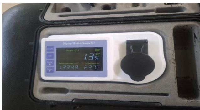
Figura 2. Refractómetro digital utilizado para la determinación de sólidos solubles (°Brix) en los sustratos fermentados
