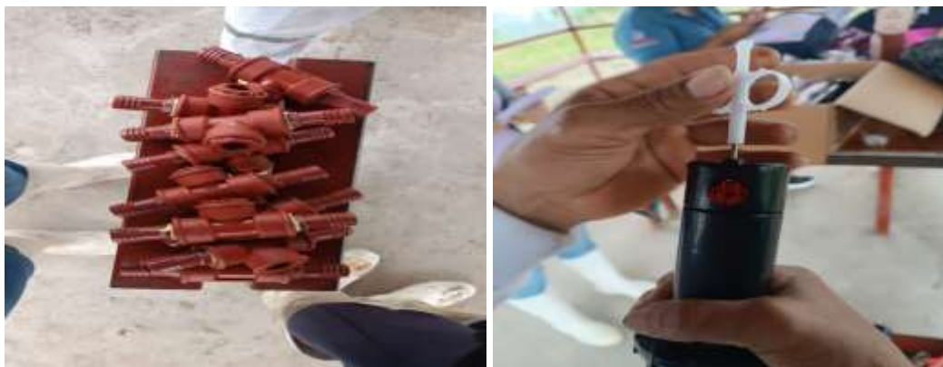
Figura 8. Válvulas y adaptadores de conexión empleados en la red de aspersión. Los componentes plásticos y metálicos se utilizaron para el control de caudal, mantenimiento sectorizado y acople de mangueras.
