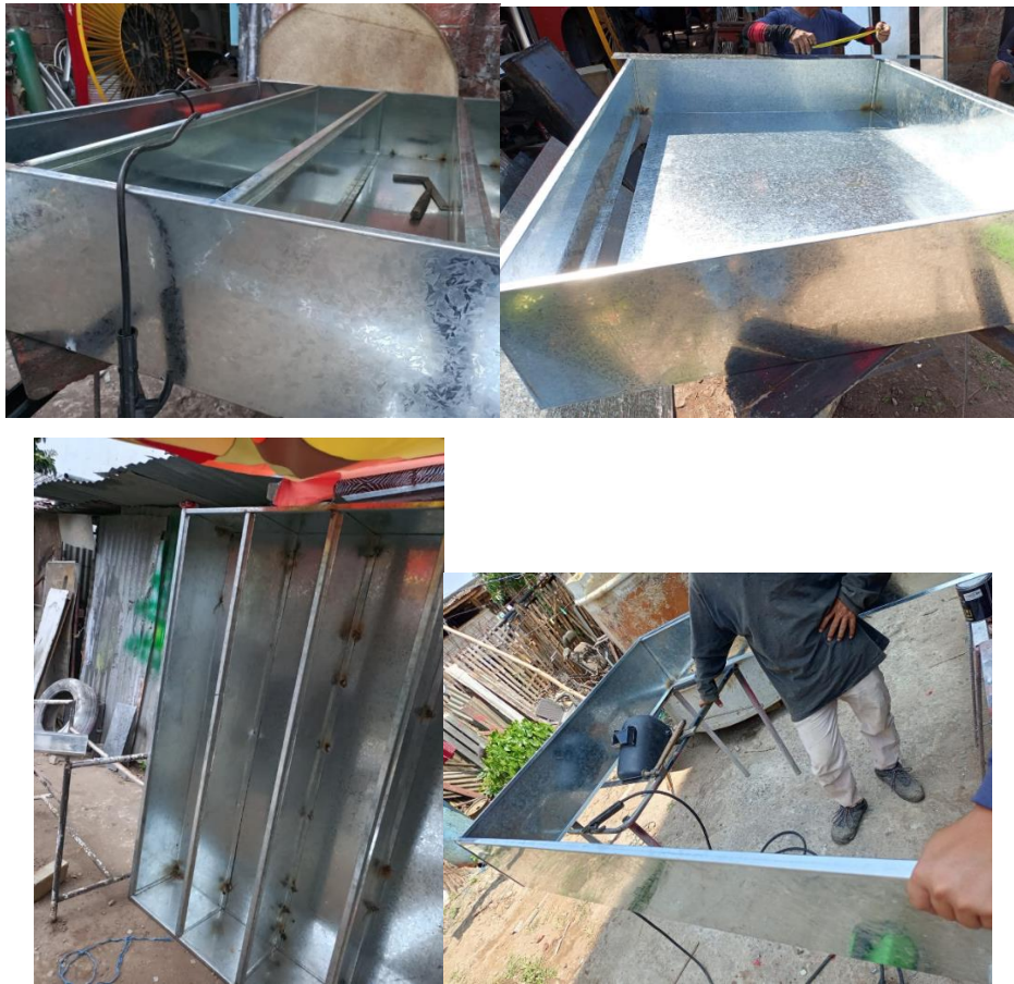
Figura 4. Armado de los lockers
