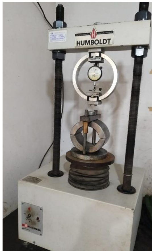
Figura 5: Prensa Marshall para determinación de estabilidad y flujo
