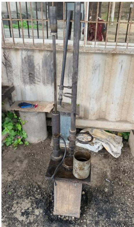
Figura 8: Compactador Marshall manual y moldes para elaboración de briquetas
