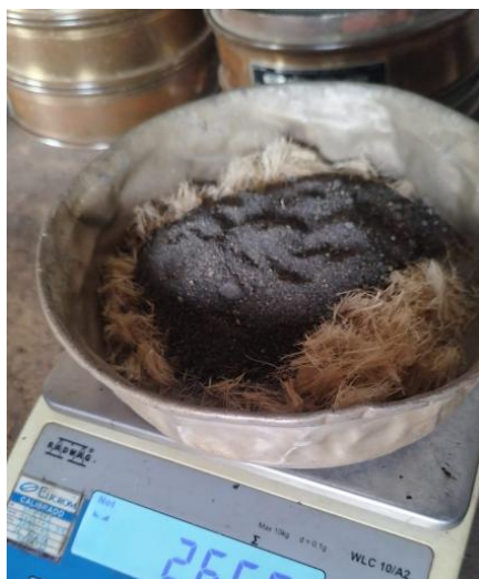
Figura 22: Pesaje e incorporación de fibra por método de adición (0,3%–0,5%)
