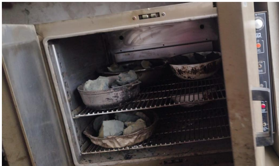
Figura 6: Horno industrial para secado y calentamiento de agregados
