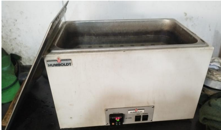
Figura 4: Calentador a Baño María termostataado para acondicionamiento de briquetas
