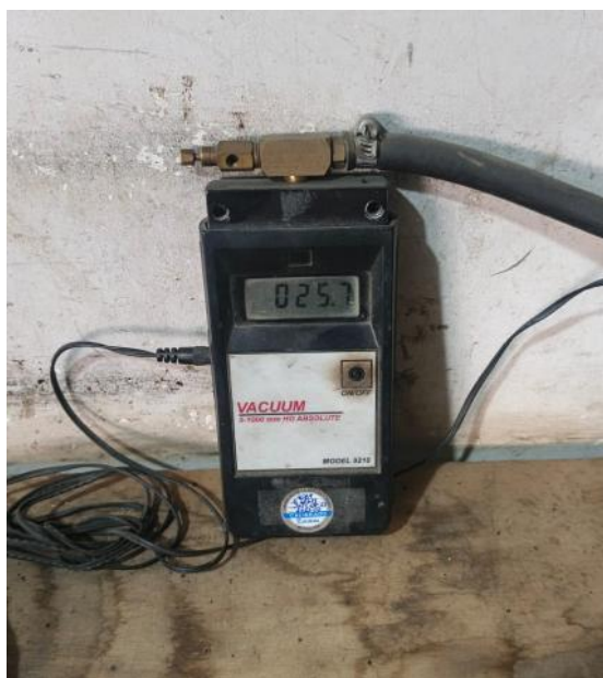
Figura 9: Manómetro del sistema de vacío para ensayo Rice (control de presión/vacío)
