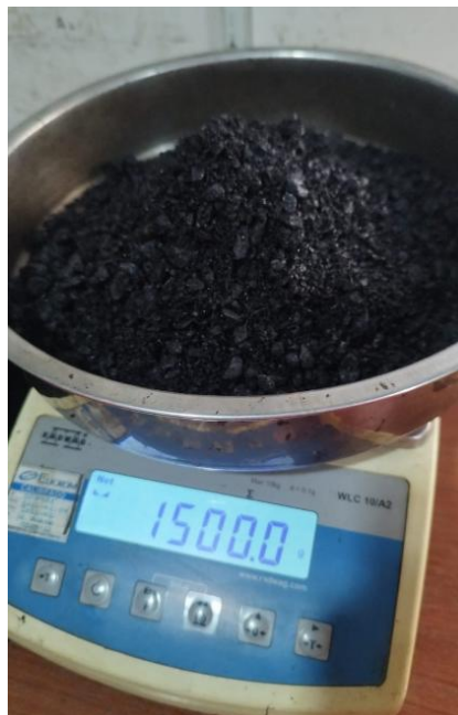
Figura 15: Preparación y mezclado en caliente de briquetas de control
