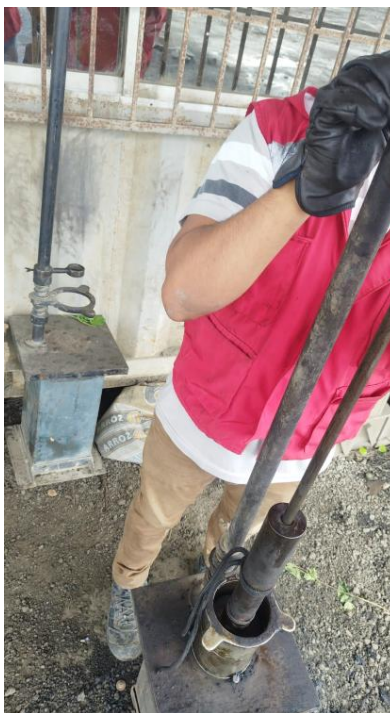
Figura 16: Compactación Marshall (75 golpes por cara) en briquetas de control
