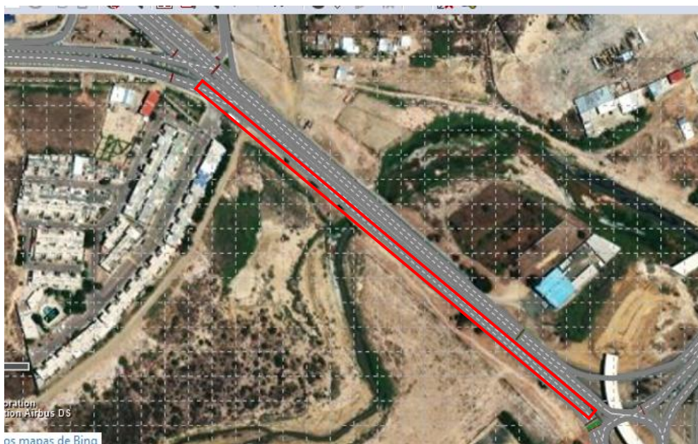
Ilustración 27. Imagen geométrica del carril agregado en la ruta spondylus en Vissim Fuente: Vissim
