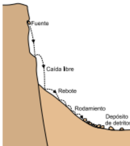
Figura 3. Esquema de la caída de rocas
