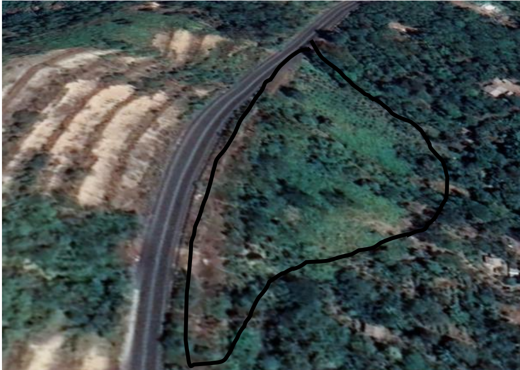
Figura 19. Área de talud con leve presencia de movimiento en suelo (2022)
