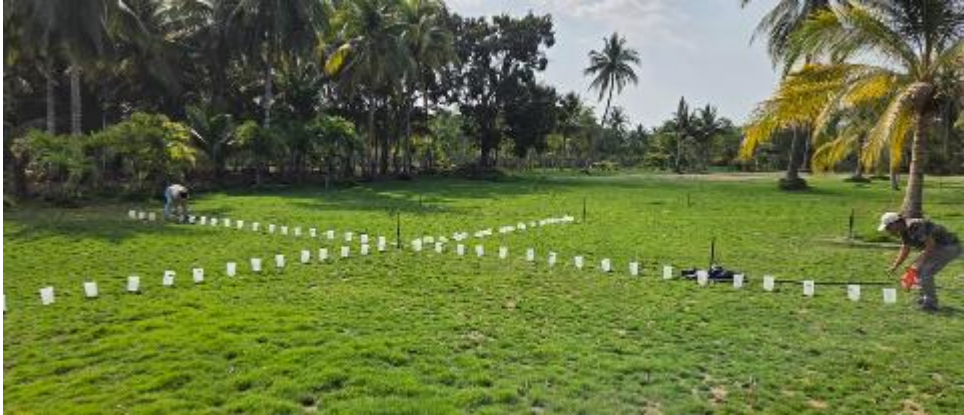
Figura 46. Colocación de pluviómetros para pruebas
