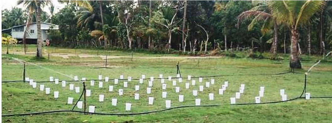
Figura 11: Ensayo pluviométrico para campo completo 7 x 8 m
