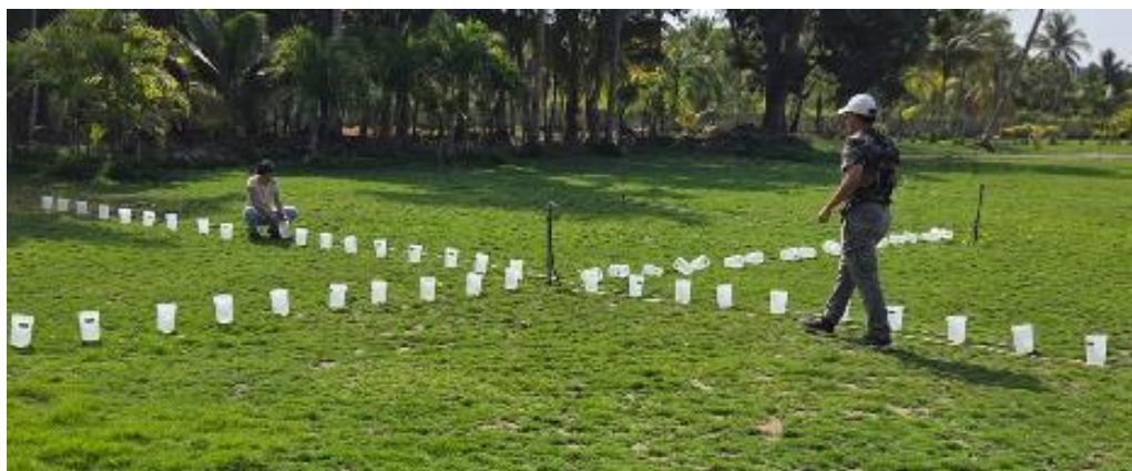
Figura 10. Colocación de pluviómetros para ensayo método radial.
