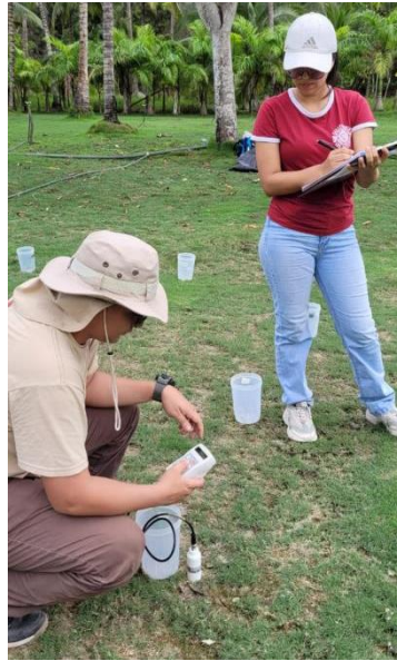
Figura 13: Medición de Humedad del Suelo
