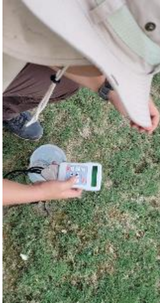
Figura 50. Medición de humedad del suelo
