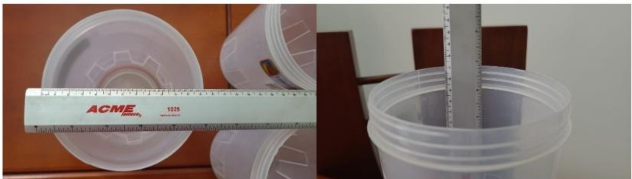
Figura 4. Medidas del colector para ensayos de Pluviometría.
