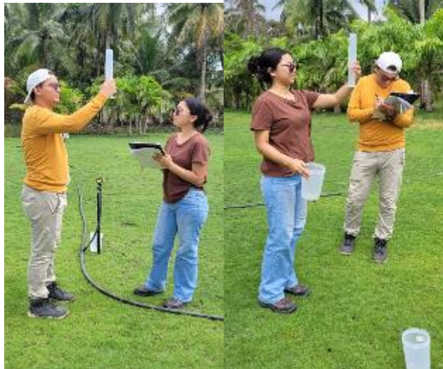
Figura 48. Toma de datos obtenidos en pruebas pluviométricas
