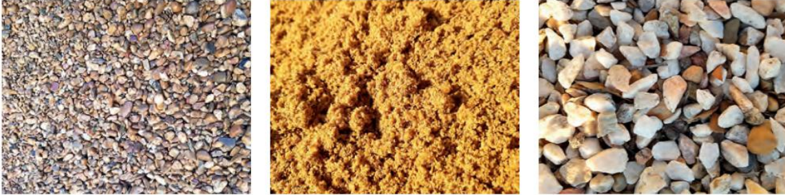
Figura 2.2.2-1.- Árido grueso de canto rodado, árido fino de río y árido grueso machacado. Recuperado de: (Moreno, 2021).
