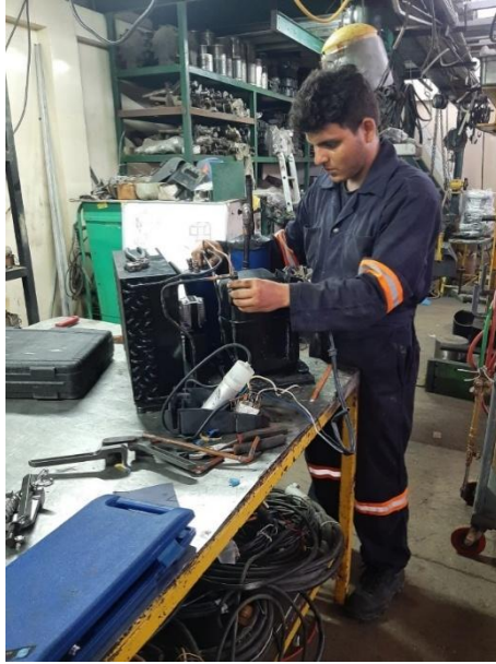
Conexión de las cañerías de la recuperadora de refrigerante. Elaborada por el autor
