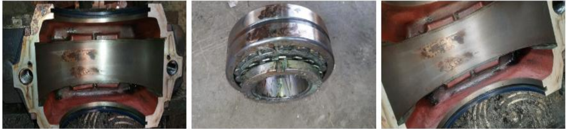
Figura 5: Corrosión por contacto (SEDISA)
