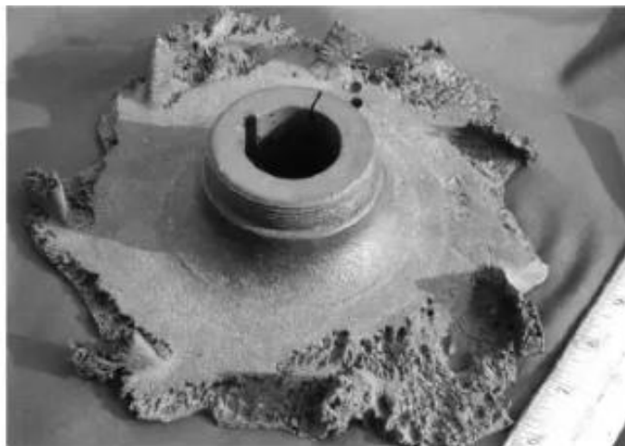
Figura 4:Corrosión conjunto con cavitación (Canchon, 2018)
