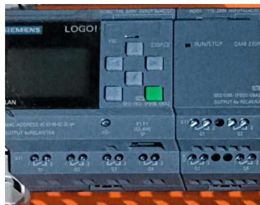
Figura 27 PLC acoplado con módulo de expansión
