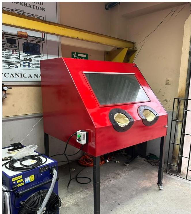
Ilustración 6 Cámara de Sandblasting
