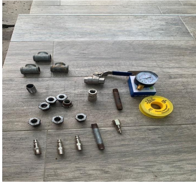
Ilustración 2 Materiales usados para construcción de sandblaster
