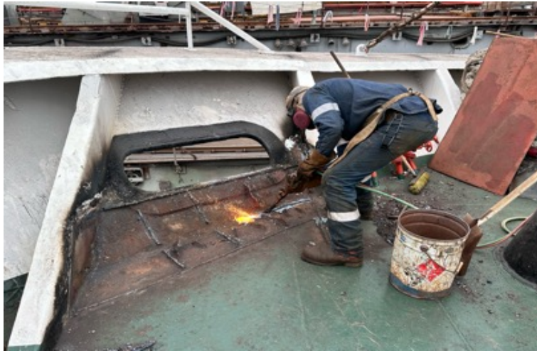
Ilustración 19: Corte de sección
