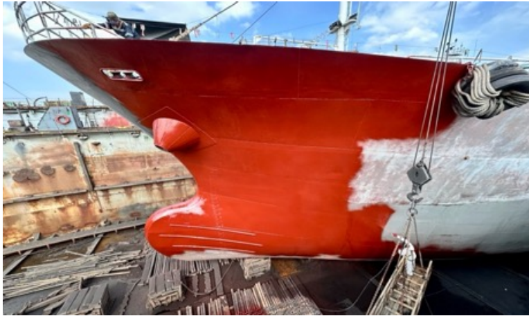
Ilustración 10: Aplicación de la capa de pintura antifouling en Proa
