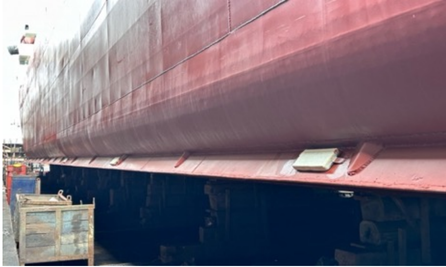
Ilustración 13: Colocación de los ánodos de zinc en los Flaps del casco.
