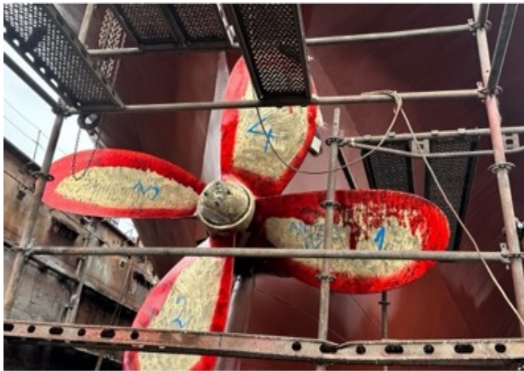
Ilustración 6: Prueba parcial de líquidos penetrantes a las aspas de la hélice
