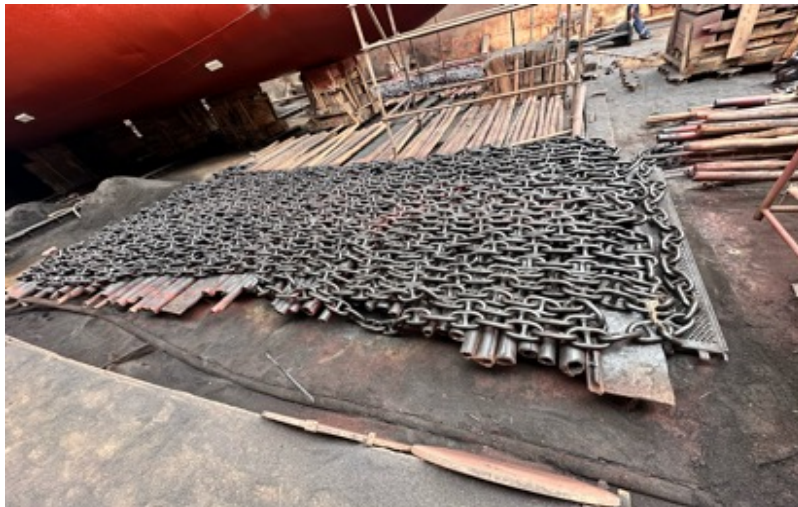
Ilustración 15: Cadena del anclaje en proceso de mantenimiento preventivo.
