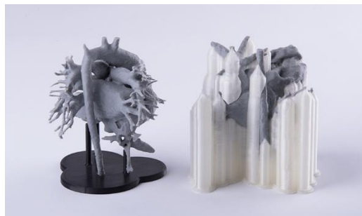
Ilustración 6. Filamento PVA usada en soportes
