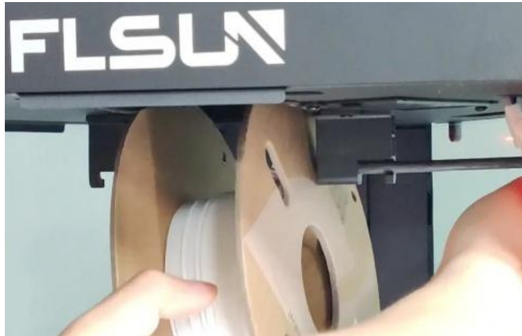
Ilustración 24 Montaje de filamento en impresora
