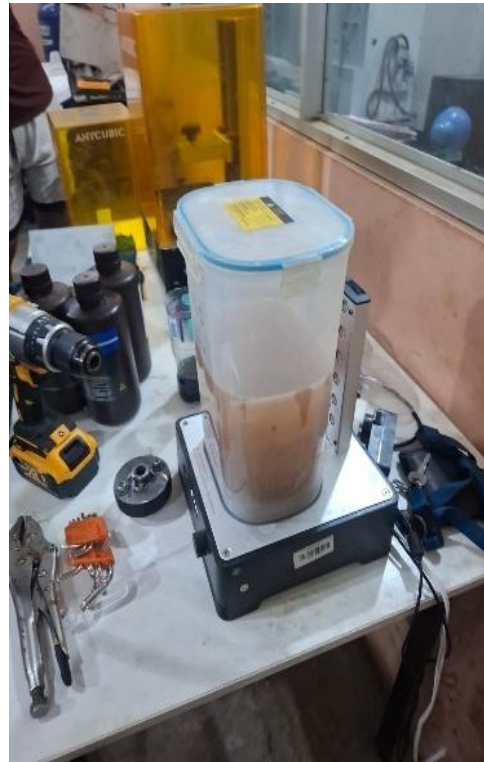
5 min de lavado de pieza en alcohol
