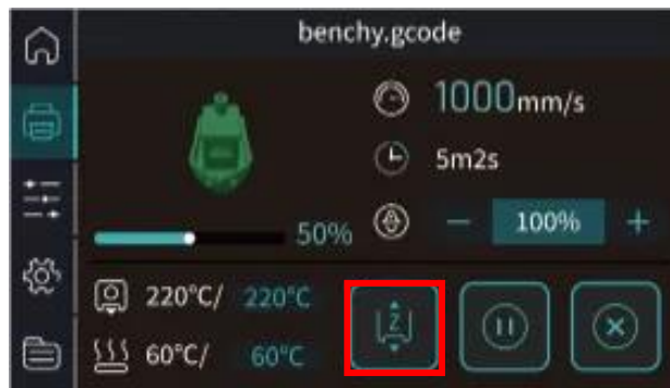
Ilustración 28 Opción de ajuste de boquilla
