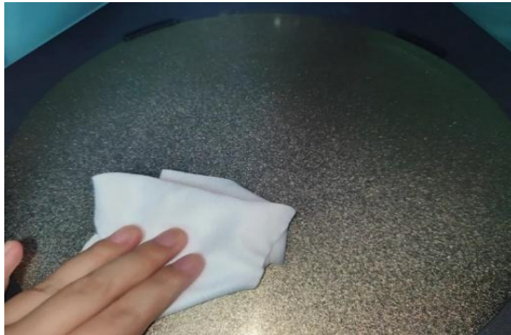
Ilustración 30 Limpieza de cama caliente
