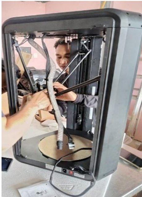
Ilustración 19 Montaje de extrusor de filamento
