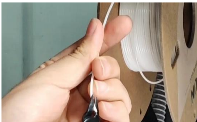
Ilustración 25 Corte de filamento a 45°
