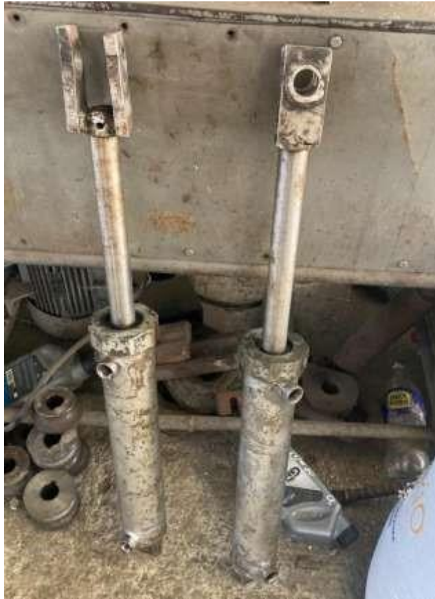
Ilustración 34 Gatos hidráulicos previos a reparación
