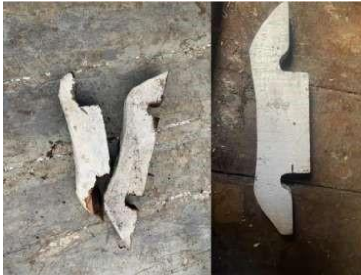
Ilustración 31 Antes y después de soporte de tuberías
