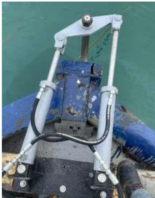
Ilustración 19 Gatos hidráulicos de la embarcación "El Rey" después de limpieza interna y externa
