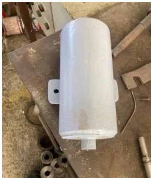
Ilustración 11 Tanque de compensación reparado y pintado de la embarcación "El Rey"
