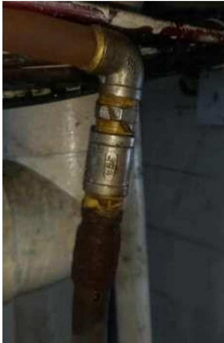
Ilustración 14 Accesorios con corrosión mínima de la embarcación "El Rey"
