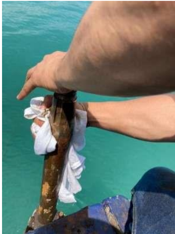
Ilustración 16 Soporte macho del abanico corroído de la embarcación "El Rey"
