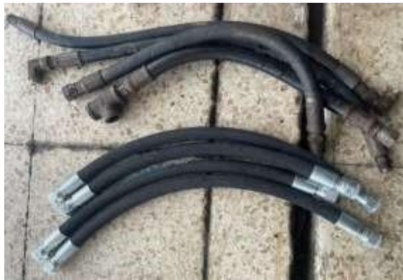
Ilustración 26 Mangueras nuevas para tanque de compensación
