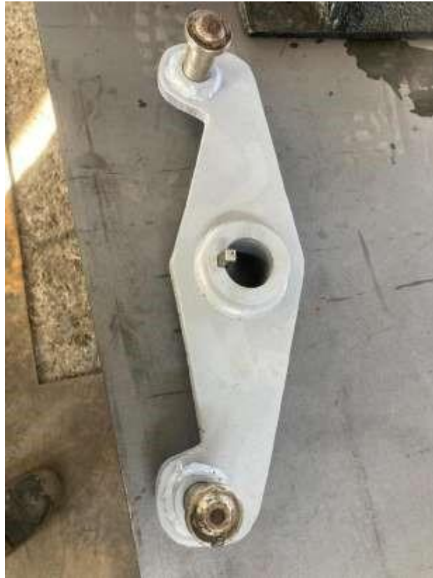
Ilustración 37 Abanico nuevo fabricado en el torno
