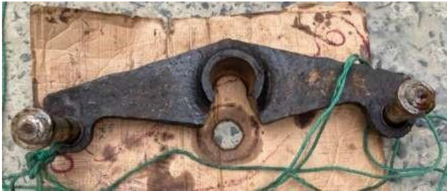
Ilustración 36 Abanico antiguo de la embarcación "El Rey" corroído en su totalidad
