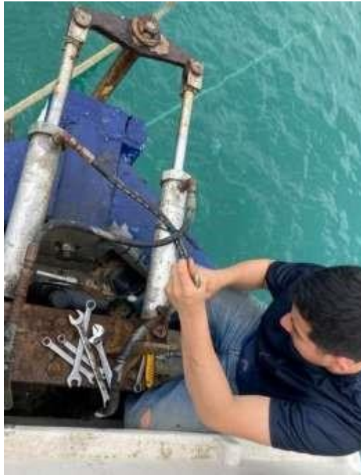
Ilustración 18 Gatos hidráulicos de la embarcación "El Rey" en mal estado y con fuga
