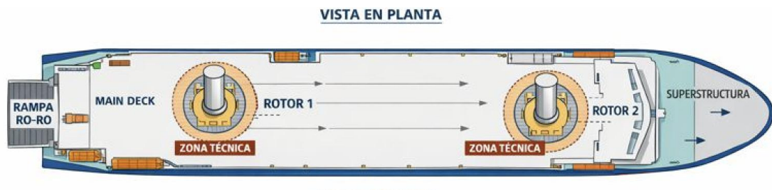
Figura 32. Vista en Planta Fuente: Adobe Illustrator
