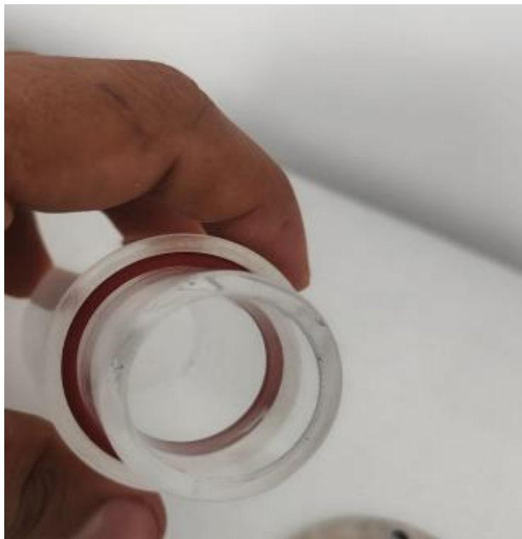
Figura 46. Inserción de sello de aislamiento entre cilindros Fuente: Autor
