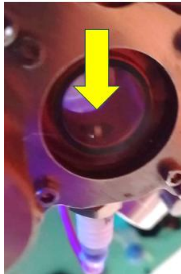
Figura 62. Presencia de primera chispa en la cámara de combustión Fuente: Autor
