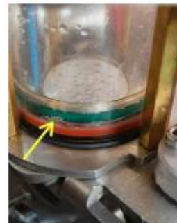
Ilustración 11 Referencia de posibles residuos en la cámara del cilindro exterior
