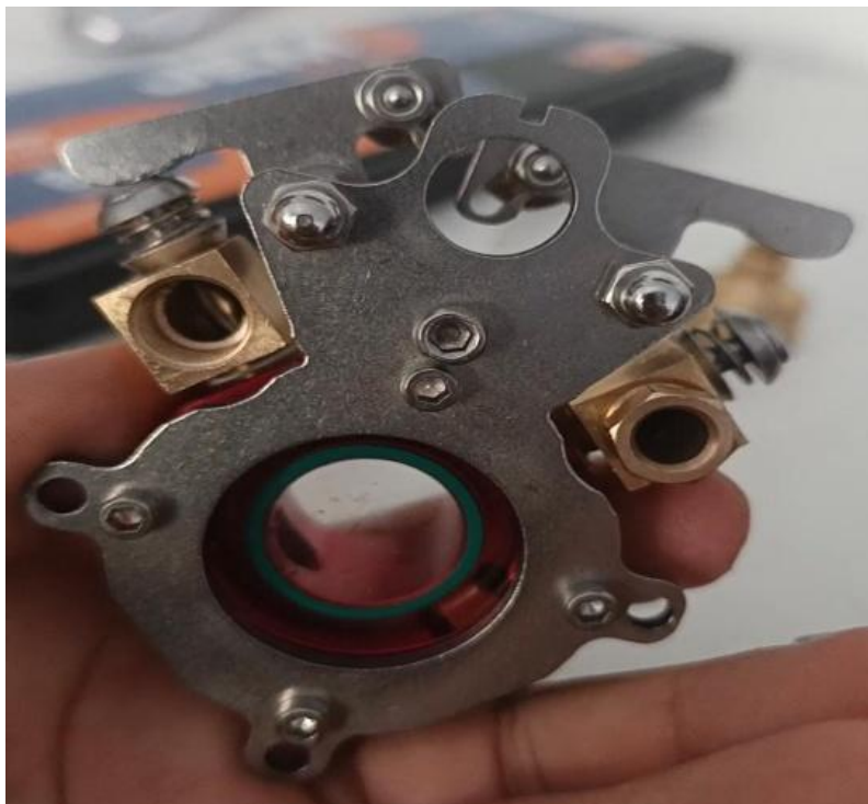
Figura 50. Escotilla de la cámara de combustión Fuente: Autor
