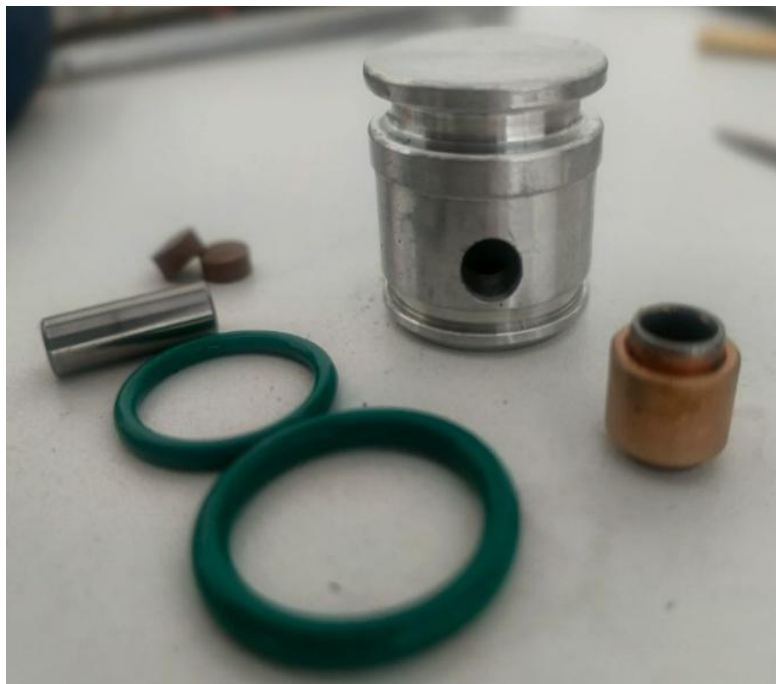
Figura 38. Anillos de goma al pistón Fuente: Autor
