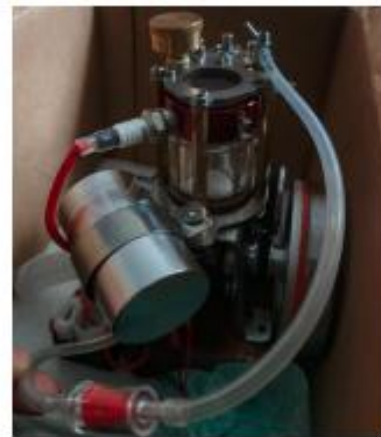
Ilustración 6. Tanque de combustible del motor
