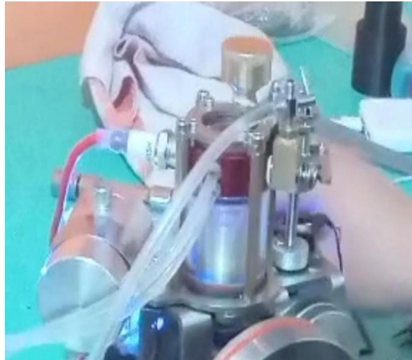
Figura 67. Pistón se dirige al punto muerto inferior (PMI) Fuente: Autor
