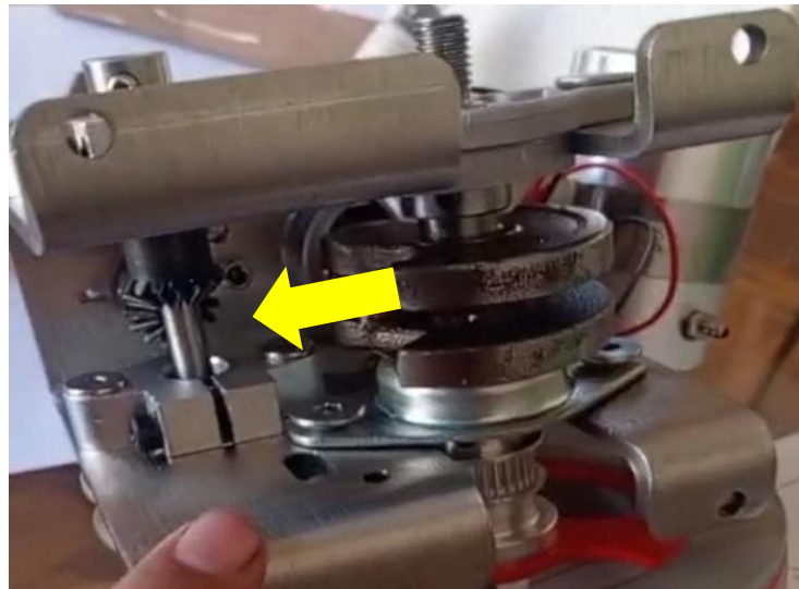
Figura 43. Alineación de eje de polea, con árbol de levas Fuente: Autor
