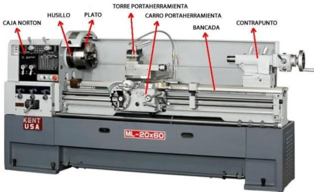
Imagen 4. Partes de un torno. Área tecnológica
