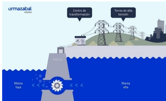
Ilustración 8: Funcionamiento de una presa de marea.
