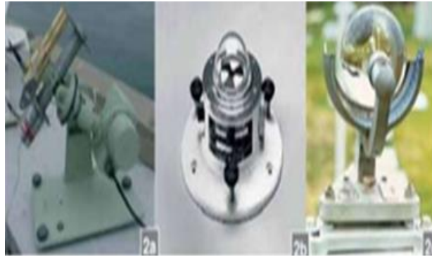
Ilustración 2: Medición de la energía mediante Pirheliómetro, Piranómetro, Heliómetro.
