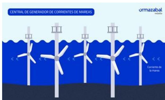
Ilustración 9: Funcionamiento de una central corriente de marea
