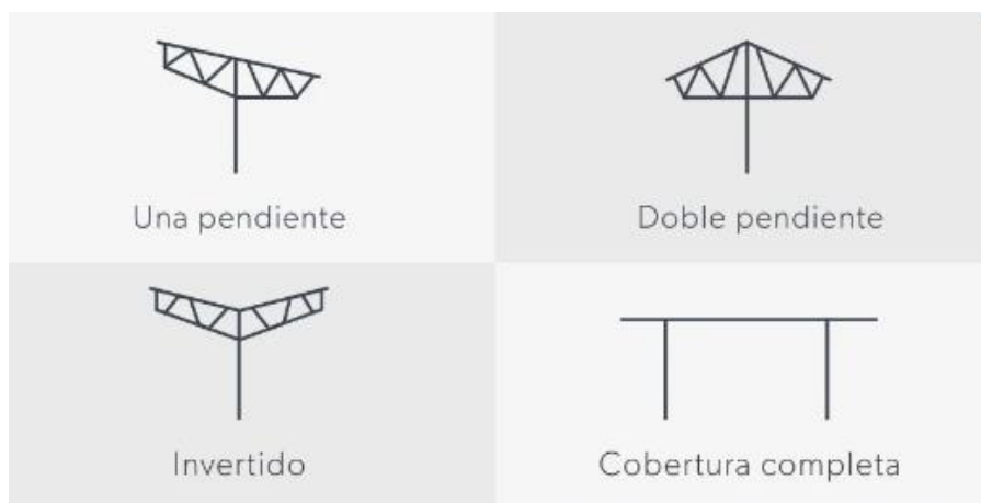
Ilustración 31: Tipos de estructuras
