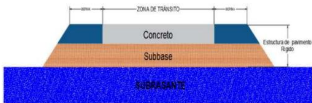
Figura 1 Estructura del pavimento rígido
