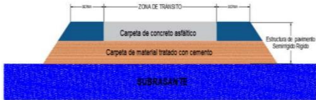
Figura 3 Estructura del pavimento semirrígido
