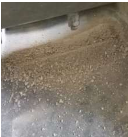
Anexos 1 Estado del agregado de concha negra tras el ensayo de resistencia a la degradación (Máquina de los Ángeles). Fuente: Propia
