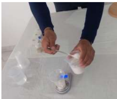
Anexos 3. Fabricación de Cubos de Yeso Normal y Yeso Modificados. Fuente: Propia
